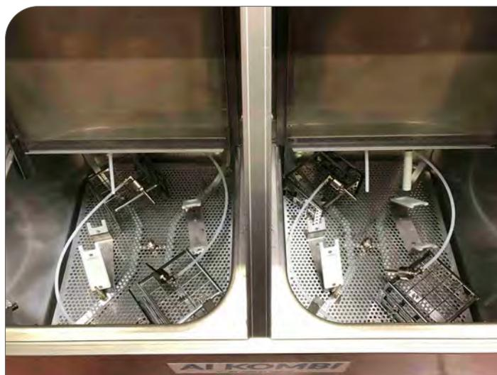
2 bacs de lavage pour nettoyer simultanément, par bac, jusqu'à 2 pistolets gravité et 1 autre pistolet sans godet.
